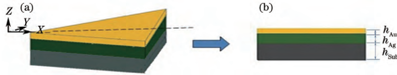
图 1 金银复合三角形纳米粒子的示意图。(a) 三维示意图; (b) 横截面图
