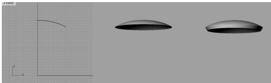
图3 (a)数据点系列构成曲线;(b)旋转命令得到自由曲面面型;(c)填充实体模型
