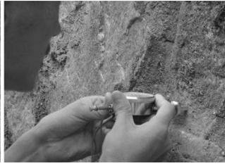
图8 砂浆强度现场检测
