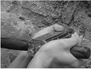
图7 砂浆强度现场检测
