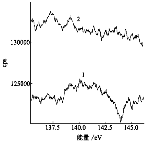
图 5 (dsDNA)_b\text{-SAM/Au} (曲线 1)和对照实验电极(曲线 2)的 P_{2p} 特征峰区的 XPS 谱图
