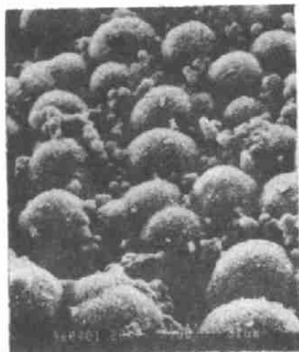
图2 分子筛膜的扫描电镜(SEM)照片
