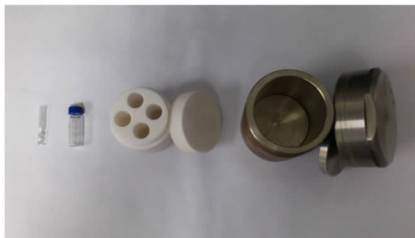
图 2 自制耐压多样品微量衍生反应装置 Fig. 2 Home-made multi-micro-volume pressure-assisted derivatization reaction device
