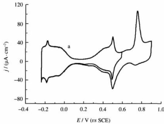
图1 高氯酸介质中Pt(111)-I电极的循环伏安(CV)曲线
