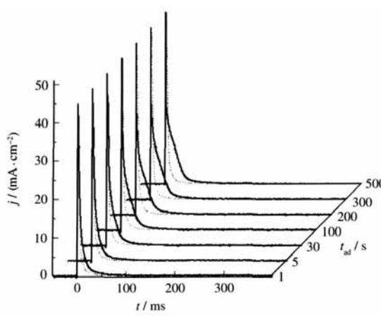
图 2  $E_{\text{ad}}=0.10 \text{ V}$  时几个不同吸附时间  $t_{\text{ad}}$  下的  $j-t$  暂态曲线
