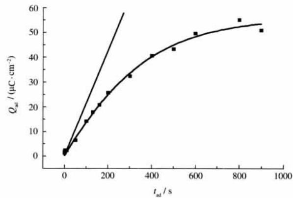
图 6  $E_{\text{ad}}=0.10 \text{ V}$  时 Pt(111)-II 电极  $Q_{\text{ad}}$  随  $t_{\text{ad}}$  的变化
