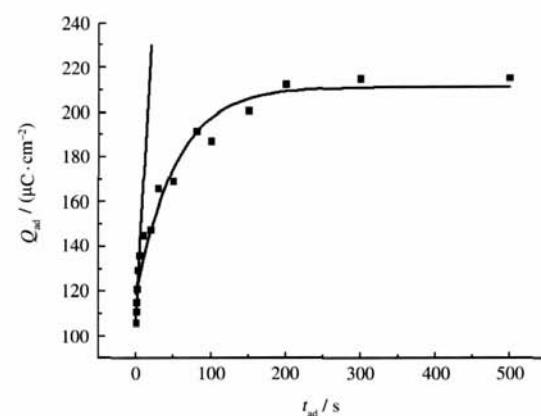
图 3  $E_{\text{ad}}=0.10 \text{ V}$  时 HClO<sub>4</sub> 介质中  $Q_{\text{ad}}$  随  $t_{\text{ad}}$  的变化
