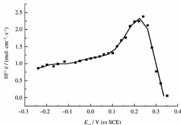
图 4 高氯酸介质中 Pt(111)-I 上 EG 解离吸附的平均速率(30 s 区域)随  $E_{\text{ad}}$  的分布
