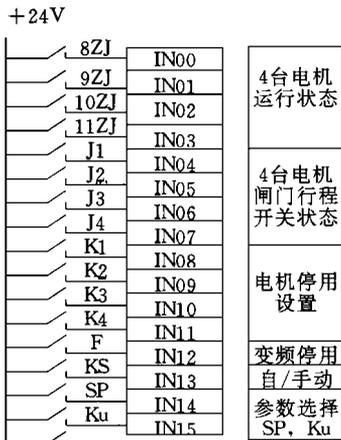
图 4 输入模块 1746IB16
