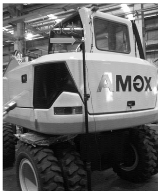
图6 排气尾管噪声测试现场图片
