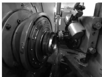
图9 非对称弧齿锥齿轮加工现场
