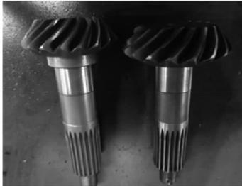
图 11 非对称弧齿锥齿轮与原对称齿轮主动轮
