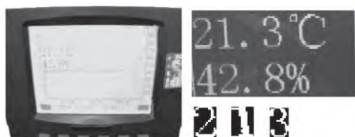
(a) 蓝色分量为灰度所得的图像 (b) 截取的待识别区域和温度值处理结果
