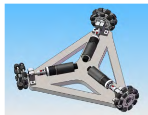
图1 全向轮装配模型
