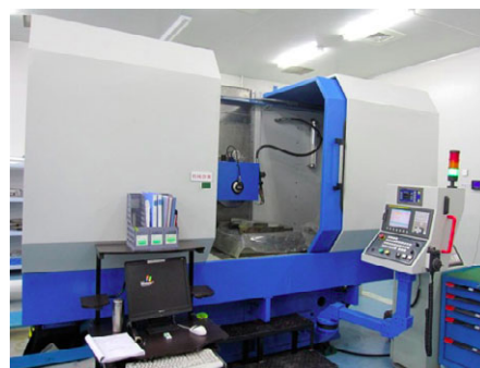
图 1 精密磨削机床 2MK1760
