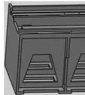
图 9 横向加筋后的床身的剖面图
