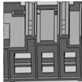
图 10 纵向加筋前的床身的剖面图
