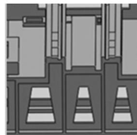
图 11 纵向加筋后的床身的剖面图
