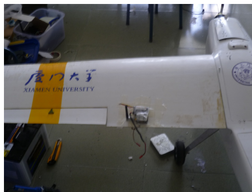
图7 搭载航模的无线电微多光谱遥感系统实物图
