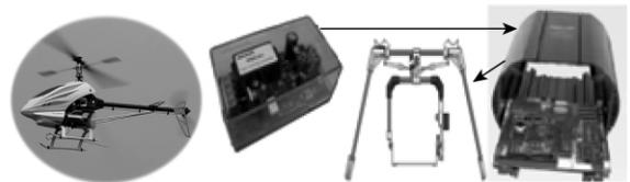
图 8 无人直升机系统集成结构图
