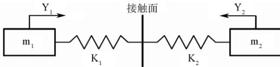
图 1 简单集中参数侧面碰撞模型
