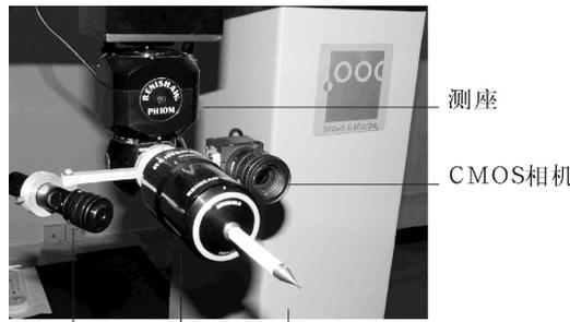
图1 多传感器集成系统安装于三坐标机测座上
