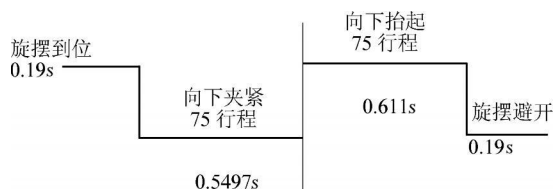
图 4 气缸转动惯量与动作时间关系
