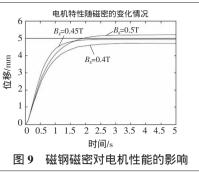
5.6%。随着磁密的增大,响应时间逐渐变大,而稳态误差却是先变大后变小。所以得到结论是,电机的稳态误差随着磁密的增大先变大后减小,在  $B_s$ =0.45~0.5T 期间存在一个临界的磁密值,使得稳态误差能达到最小值,而电机的响应时间却是一直增大的趋势。
