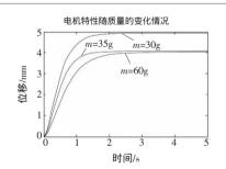
图 8 电机动子质量对电机性能的影响
