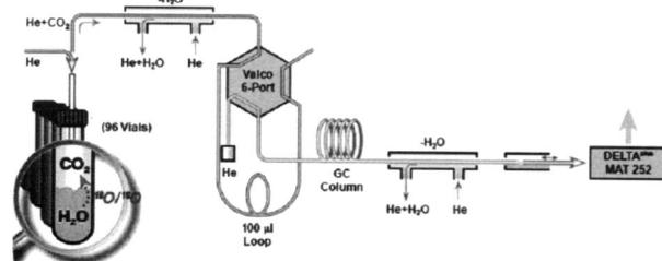
图1 GasBench与DELTA<sup>PLUS</sup>/XP联用测定CO<sub>2</sub>流程
