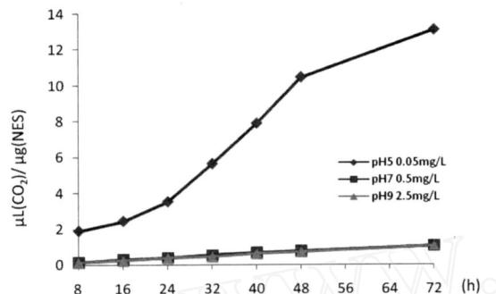
图 2 不同 pH 和浓度 NES 光照降解不同时间 CO<sub>2</sub> 测定结果Fig. 2 Determination of CO<sub>2</sub> in NES photolysis with different pH values and concentrations
