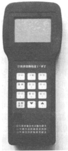
图 4 氯硝柳胺现场检测仪实物图
