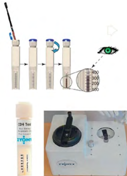
图9 基于高度计数法的 CD4+ T 淋巴细胞检测微流控芯片 [59]
