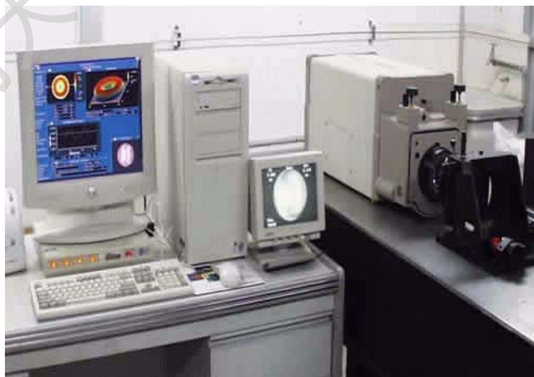
图 1.3 Mark IV 型干涉仪
