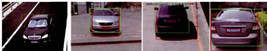
图中, 车牌定位结果用红色小矩形标出, 车辆可疑区域用绿色矩形标出. 结合车牌定位和车辆可疑区域定位结果, 得到车辆位置, 使用红色矩形标出.
