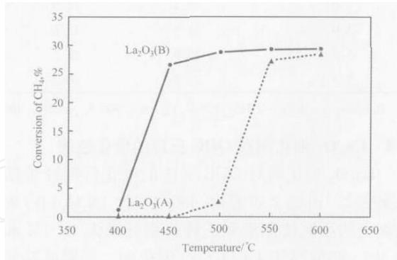
图5  $\text{La}_2\text{O}_3$  催化剂上甲烷的转化率
