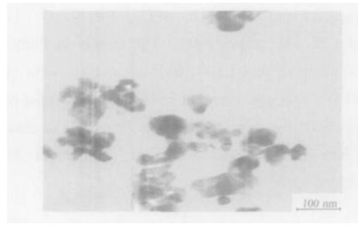
图 2  $\text{La}_2\text{O}_3$ (B) 催化剂的 TEM 图像
