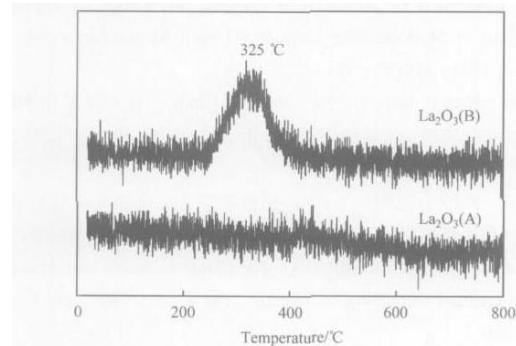
图4  $\text{La}_2\text{O}_3$  催化剂的  $\text{O}_2$ -TPD 谱图
