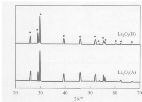
图3  $\text{La}_2\text{O}_3$  催化剂的 XRD 谱图
