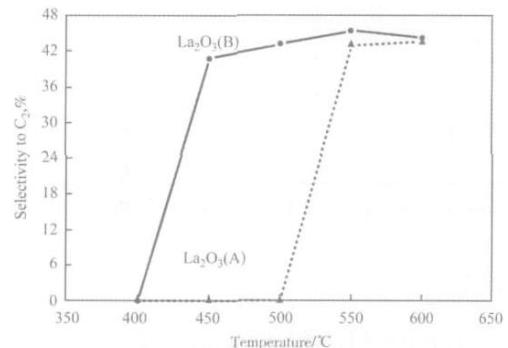
图6  $\text{La}_2\text{O}_3$  催化剂上的  $\text{C}_2$  烃选择性
