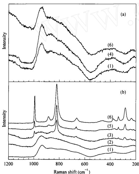
图 4 MoBiTeO/SiO<sub>2</sub> 催化剂在不同气氛下处理不同时间的原位拉曼谱
