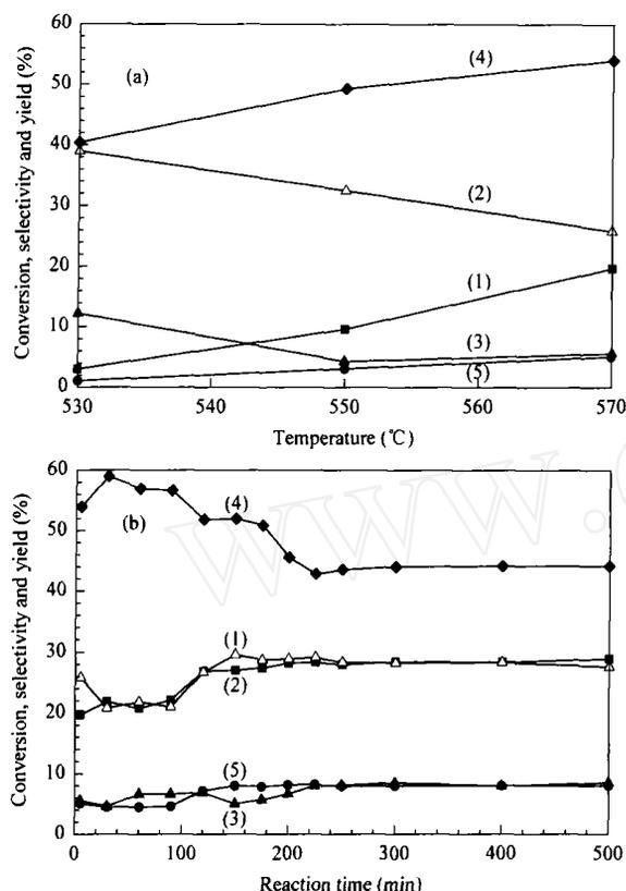
图 1 反应温度和反应时间对 MoBiTeO/SiO<sub>2</sub> 催化剂催化性能的影响
