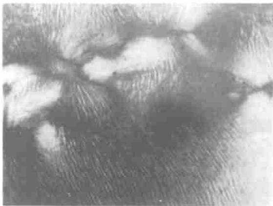
图 1 50% EC-乙酸溶液非取向膜中的条带装饰的丝状结构照片 (正交偏光 9460X)
