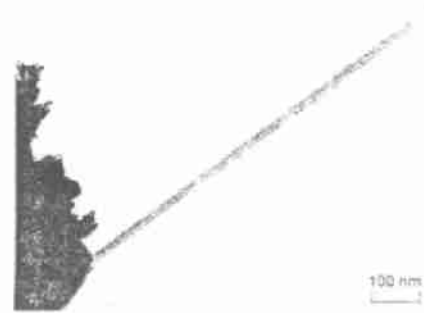
图 4 激光溅射产生的管端不含颗粒的碳纳米管的 TEM 图像
