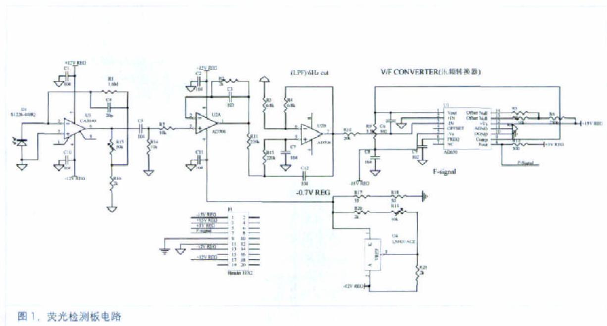
图 1. 荧光检测板电路
