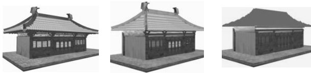
一级 LOD 实体模型 二级 LOD 实体模型 三级 LOD 实体模型图 3 三层不同级别 LOD 模型
