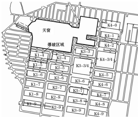
图 1 558 中段的特大爆破回采区域
