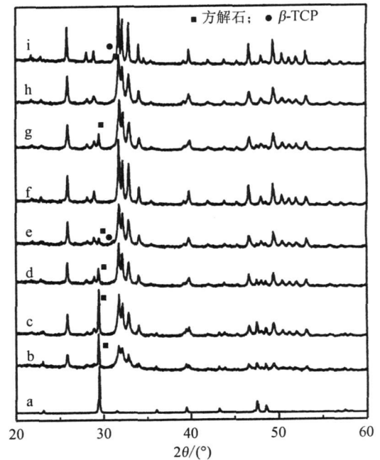
图 1 牡蛎壳粉末及其在不同条件下产物的 XRD 图谱 a. 牡蛎壳粉末; b. 牡蛎壳粉末 120 °C; c. 牡蛎壳粉末 140 °C; d. 牡蛎壳粉末 180 °C; e. 牡蛎壳粉末 180 °C; f. CaCO 3 180 °C; g. 牡蛎壳粉末 220 °C; h. 牡蛎壳粉末 220 °C; i. h 在 900 °C 煅烧 3 h. b, c, d, g 的 Ca/P 摩尔比为 5: 3, 反应 6 h; e, f, h 的 Ca/P 摩尔比为 5: 6, 反应 6 h
