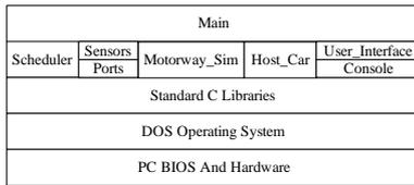
图 3 ACCS 的软件层次结构
