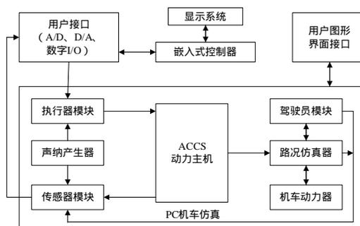
图 1 汽车 ACCS 的 HIL 平台硬件逻辑
