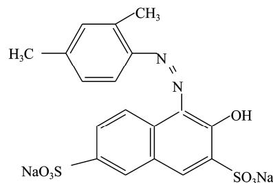
图 1 丽春红 2R 的化学结构式
