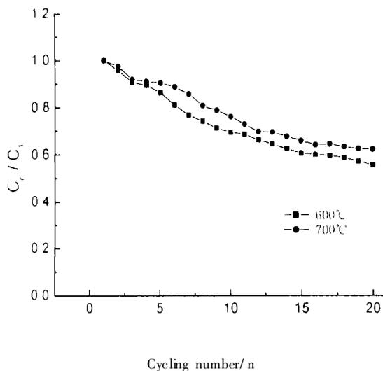
图 5 碳纤维的充放电循环性能
