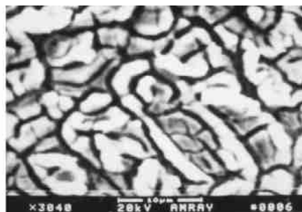
图 2 纳米 TiO_2 膜在 T = 723\text{ K} 温度下煅烧 0.5 h 后的 SEM 照片
