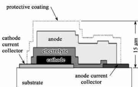
图 1 一种薄膜锂电池的剖示结构图<sup>[110]</sup>
