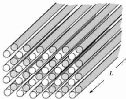
图4 三维微电池柱状阴极(灰色)阳极(白色)交互排列的立体示意图<sup>[113]</sup>
