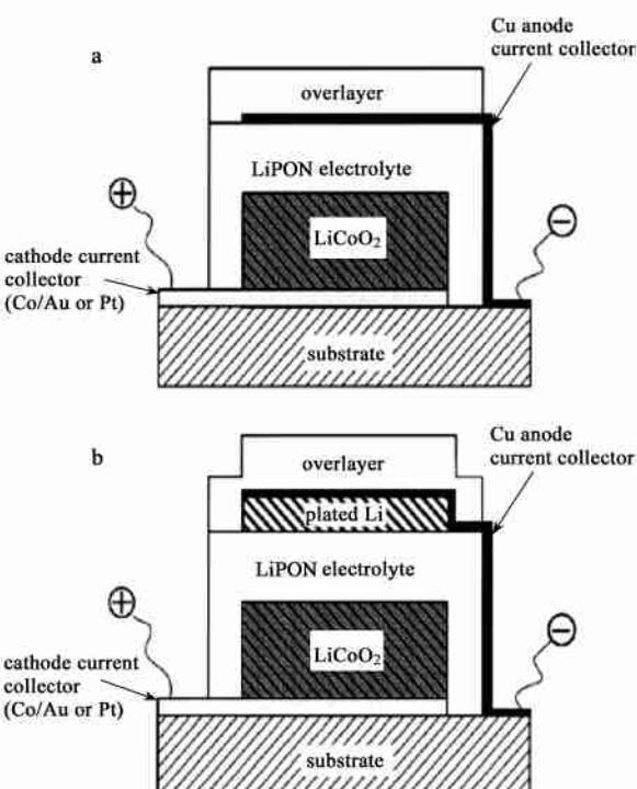
图 2 一种现场生成锂阳极的无锂薄膜电池的剖示结构
