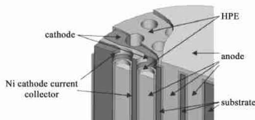
图5 一种三维薄膜电池的示意图<sup>[114]</sup>
