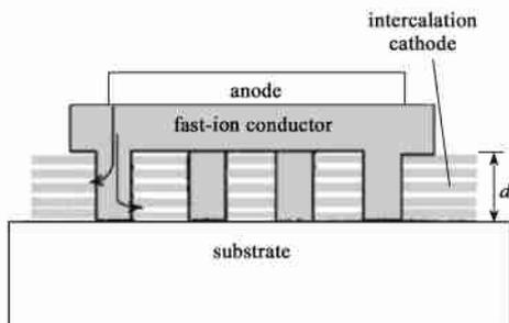
图 3 一种便于锂离子嵌脱的刻蚀得到的阴极结构图<sup>[112]</sup>
