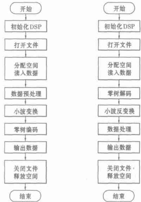
图6 (a)发送端流程图 (b)接收端流程图
