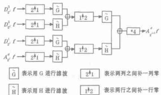
图 3 二维小波重构算法流程图
