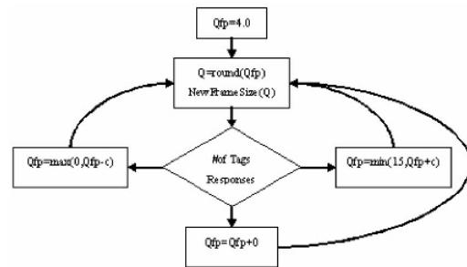
图 5 Q-Algorithm 的实现流程框图
