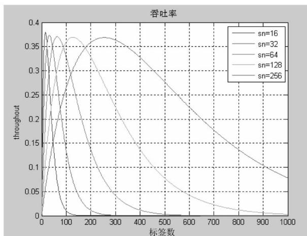
图 2 RFID 系统防冲突算法的吞吐率仿真结果
