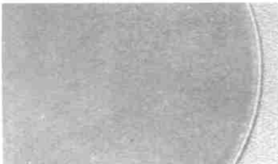
图 8 高能量、窄脉冲及等脉冲能量输出电源加工的大面积 PCD 表面
