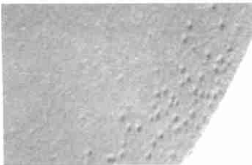
图 7 普通电源加工的大面积 PCD 表面
