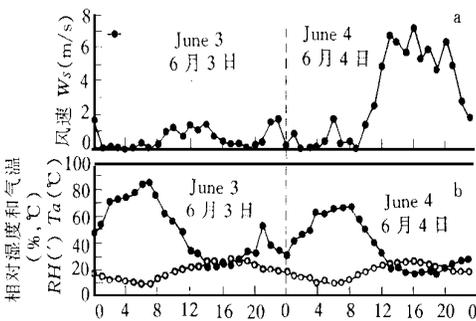
图 4 1992 年 6 月 3~4 日麦田上方 8m 高处风速 (a,  $W_s$ )、气温 ( $T_a$ ) 和相对湿度 ( $RH$ ) 的日变化
