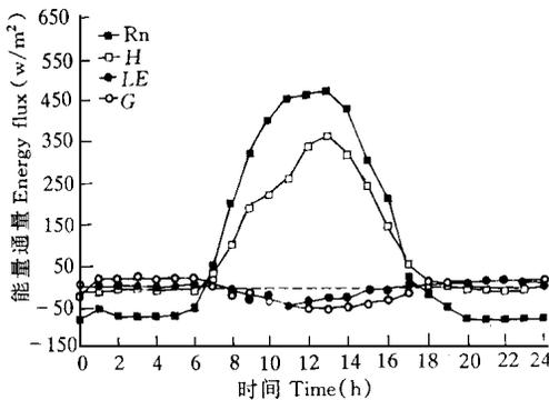
图 1 晴天沙漠生态条件下能量输送的日变化进程
