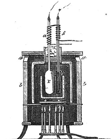
Le paracyanogène chauffé à 860 degrés se transforme complètement en cyanogène gazeux, qui atteint rapidement la pression nécessaire à sa liquéfaction dans les parties froides de l'appareil; c'est donc à une température plus basse que le phénomène de la transformation partielle est observable.
