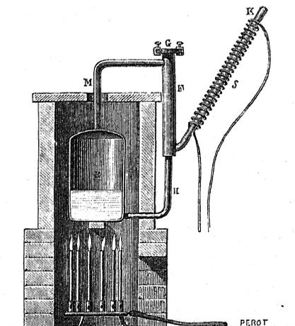
ou de soufre circule de haut en bas, et, par suite, le tube placé en F arrive à la température qu'il doit atteindre et garder pendant toute l'opération, d'abord dans sa partie supérieure, et ensuite de proche en proche, jusqu'à sa partie inférieure.
