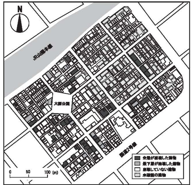
図9 高橋病院周辺での建物の損壊状況
