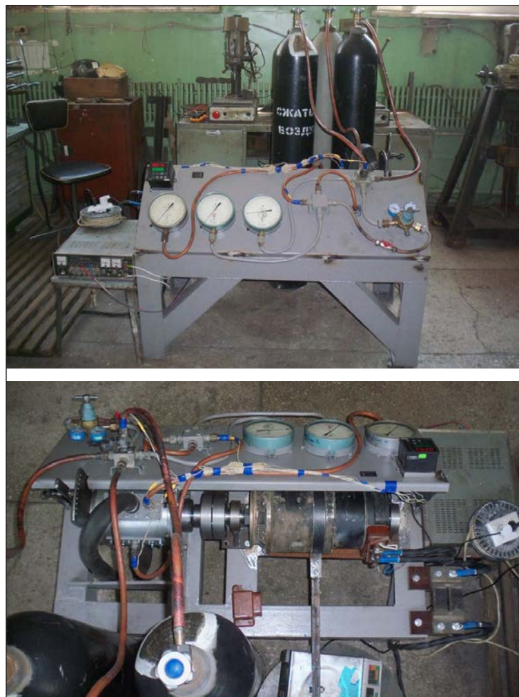
Рис. 3. Загальний вигляд експериментального стенда та панелі приладів на базі роторно-поршневого двигуна 12РПД-4,4/1,75
