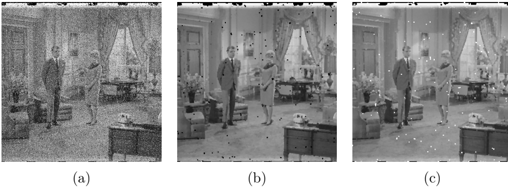
Slika 2.8: Filtriranje šuma iz (a) vhodne slike [48], kjer se filtriranje prične (b) z odpiranjem \text{IZF}_1^\gamma oziroma (c) z zapiranjem \text{IZF}_1^\varphi .
