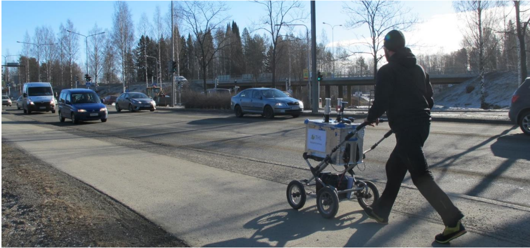
Kuva 1. Tutkija työntämässä mittausvaunua, johon henkilökohtaisen altistumisen mittauksissa käytetty laitteisto oli sijoitettu.
