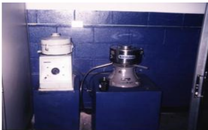
Figura 04. Extractores Centrífugos. Separa los agregados del asfalto con solvente tricloroetileno. Marca: Soiltest, Inc. (izquierda) y Freesia Macross (derecha). Fuente: Rodríguez, C & Rodríguez J., 2004, p. 140
