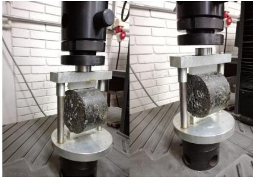
Figura 06. Proceso de falla a tracción indirecta. Fuente: Pérez, S & Lemus, W., 2018, p. 61
