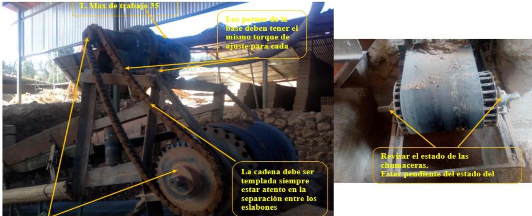
El alineamiento de entre Piñones debe tener una tolerancia Max. 1 mm. Se debe evitar el desalineamiento angular,
