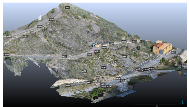
Figura 16. Nube de puntos densa georreferenciada de la ladera obtenida en la Campaña 1.
