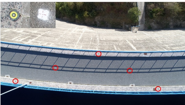
Figura 11. Tipología y distribución de GCPs. GCPs tipo placa distribuidos en las aceras y tipo marcas pintadas sobre el eje de la presa.
